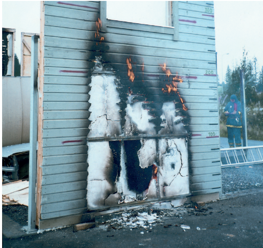
Puujulkisivun tuuletusraon vaakasuuntaisia palokatkoja tulee olla vähintään yksi kerrosta kohden, mieluiten noin metrin välein. Oikeanpuoleisessa kuvassa koeseinä on palanut polttokokeessa 100 minuuttia.
