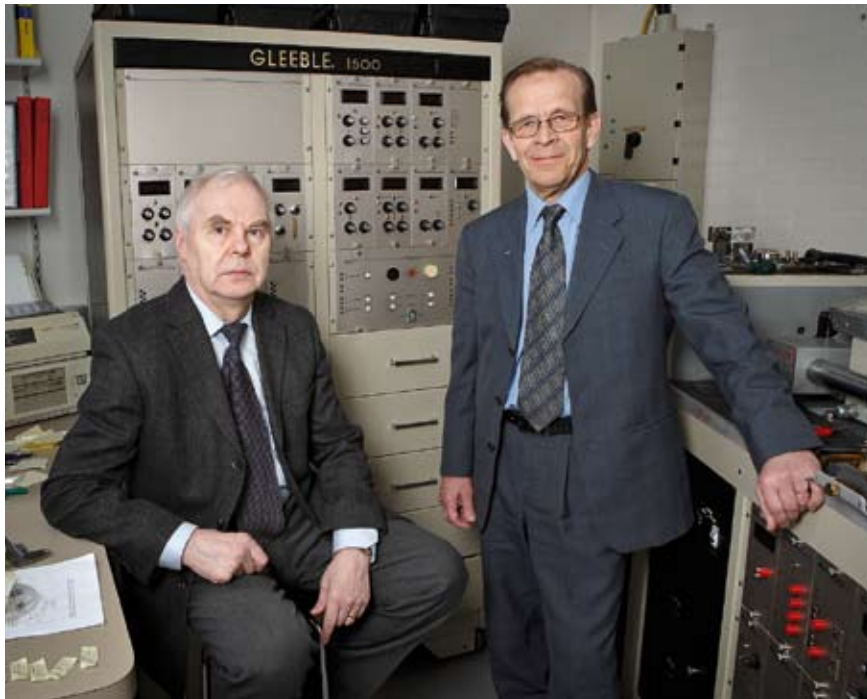
Oulun yliopiston materiaalitekniikan laboratoriossa on käytössä Suomen ainoa termomekaaninen simulaattori, jolla jäljitellään teräksen muokausprosessia. Professori Pentti Karjalainen (vasemmalla) johdolla laboratorio on yksi Rautaruukin ja sen kehitysjohtaja Veikko Heikkisen tärkeitä yhteistyökumppaneista.
