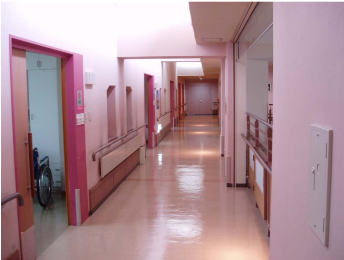
Kuva 13. Vanhainkodin leveä käytävä ja kaiteet seinissä
