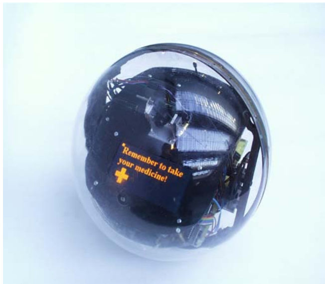
Kuva 7. Pyöreä Rollo-robotti muistuttaa lääkkeiden ottamisesta. Pallomaisen robotin sisällä akselinsa ympäri pyörivä mekanismi saa robotin pyörimään haluttuun suuntaan. Pallomainen muoto ihasuttua ja innostaa, vaikka liikkuminen matonreunojen tai kynnysten yli onkin hankalaa. [AutLab]
