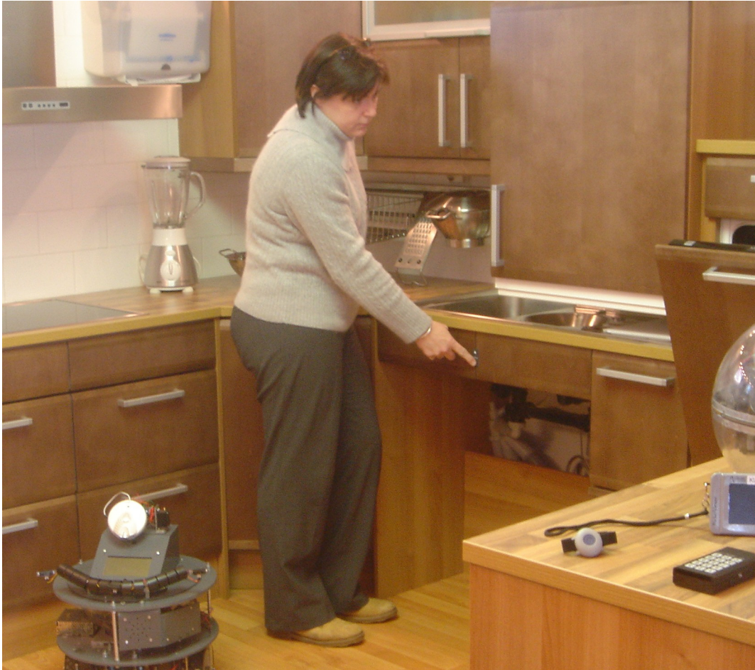
Kuva 2. Toimiva koti on Helsingin kaupungin sosiaaliviraston informaatio- ja esittelytila, jossa on erilaisia kotona selviämistä helpottavia laitteita ja ratkaisuja. Kuvassa esitellään astiakaappia, jota voidaan laskea ja nostaa pöydän reunassa olevilla painonapeilla. Lattialla oleva pölynimurirobotti on Toimivan kodin vakiokalustoa, mutta isompi robotti "Rolloottori" ja pöydällä oleva pyöreä robotti "Rollo" ovat olleet siellä vain testikäytössä. [Toimiva koti]
