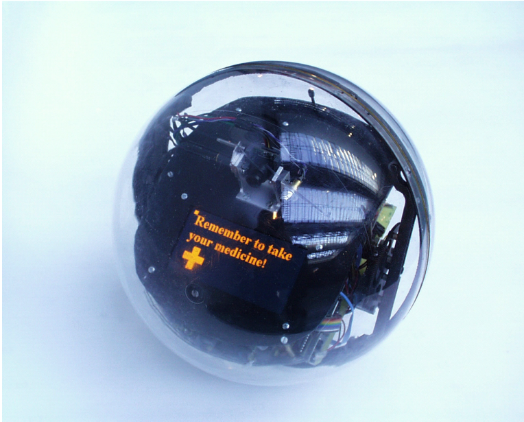
Kuva 7. Pyöreä Rollo-robotti muistuttaa lääkkeiden ottamisesta. Pallomaisen robotin sisällä akselinsa ympäri pyörivä mekanismi saa robotin pyörimään haluttuun suuntaan. Pallomainen muoto ihastuttaa ja innostaa, vaikka liikkuminen matonreunojen tai kynnysten yli onkin hankalaa. [AutLab]
