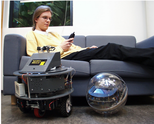
Kuva 11. Kännykällä voi ohjata sekä vasemmalla olevaa Rolloottori-robottia että pallomaista Rollo-robottia. Molemmat ottavat vastaan myös tekstiviestejä ja näyttävät ne omilla näytöillään.
