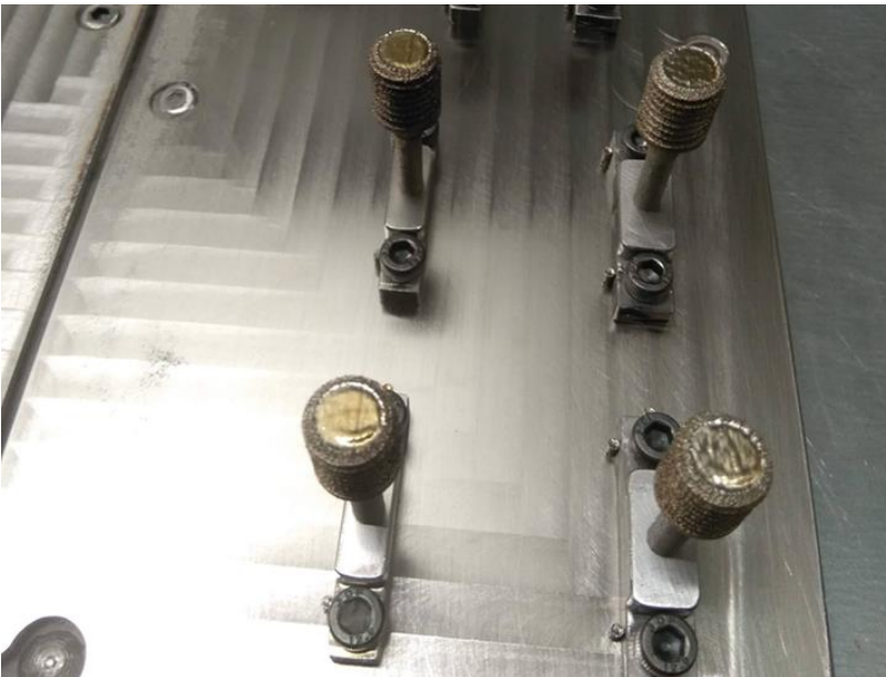
Kuva 20. Vetokoesauvoja tulostettuna levyateriaaleissa 316L ja P355GH.
