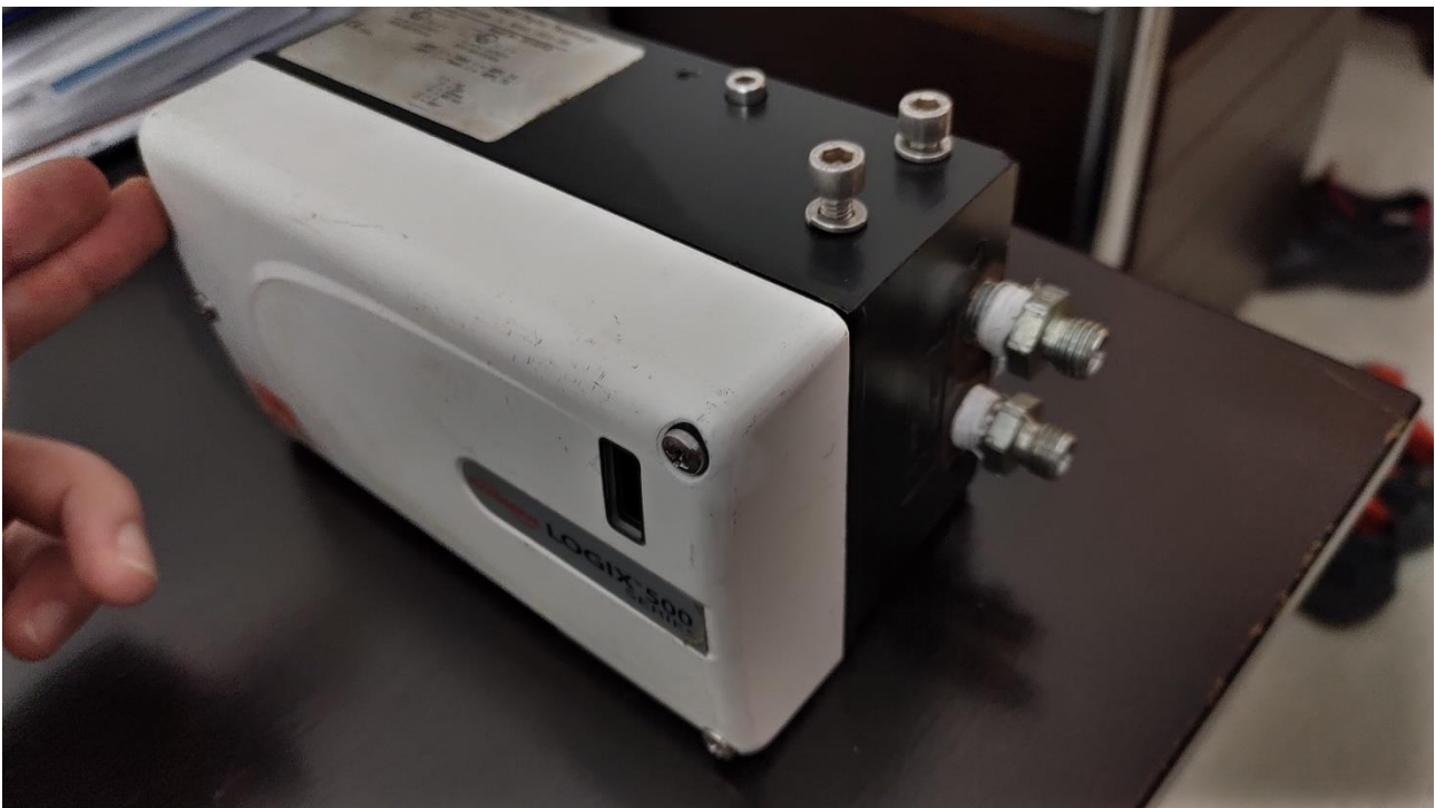
Kuva 25. Venttiin säädin koteloineen.
