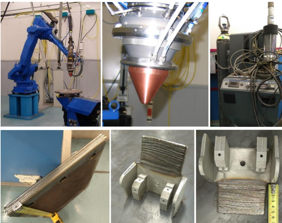
Kuva 22. Laserpinnoituspäällä varustettu robottisolu ja koepinnoitteita.
