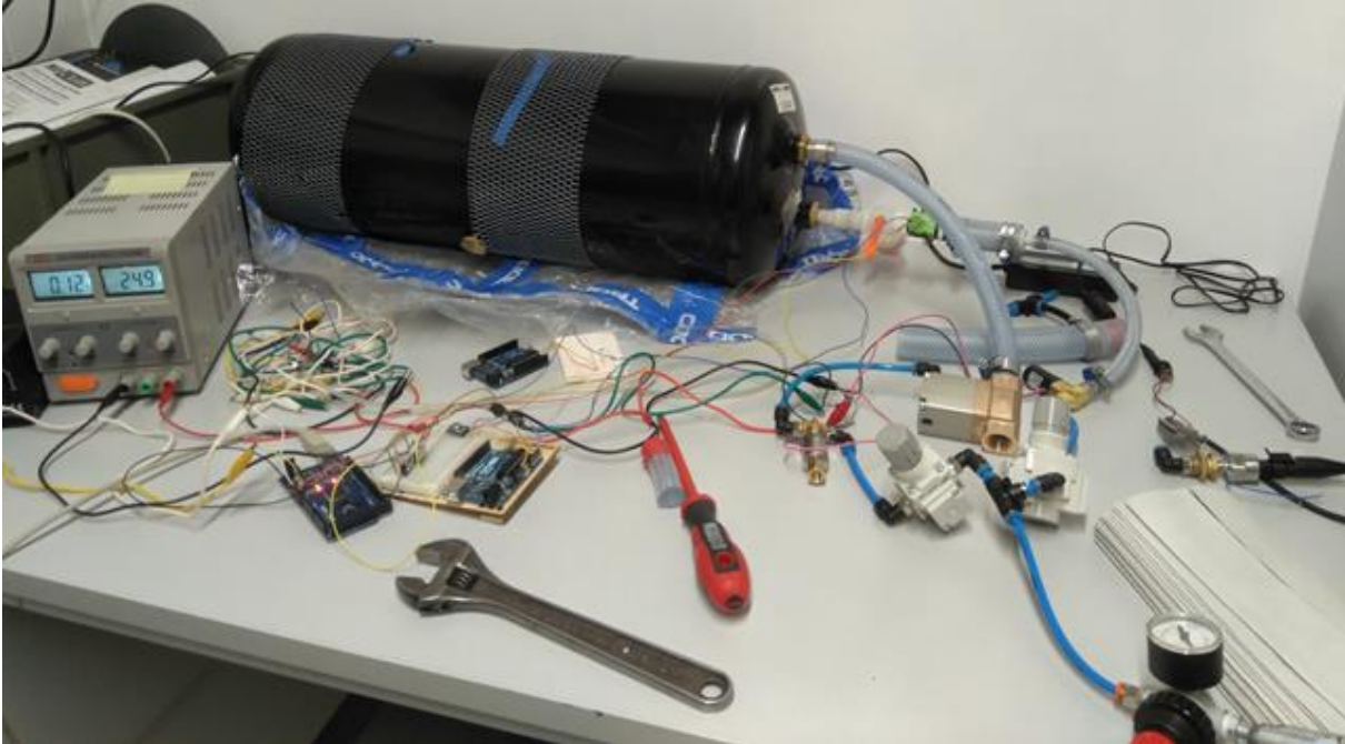
Kuva 12. Koejärjestely OP-Vent hengityskoneen suorituskyvyn mittausta varten.
