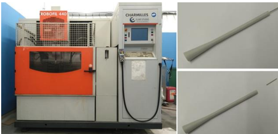
Kuva 4. Lankasaha ja suuttimen asennustyökalu.
