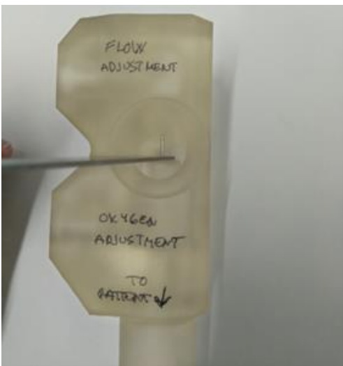
Kuva 6. Suutinetäisyyden mittausta rakotulkilla.
